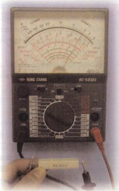
Figura 2.25. Midiendo una resistencia
